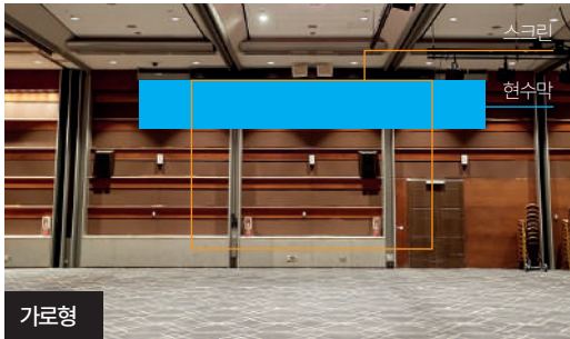
규 격 | 10(W) x 1(H) m 설치 위치 | 스크린 뒤 설치 방법 | 바텐 위 압정 또는 케이블타이 고정 현수막 가공 | 현수막 하단 봉미싱
