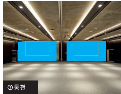
① 통천 규 격 | 5.5(W)x2.8(H)m-2식 설치 위치 | 스크린 뒤 설치 방법 | 바텐 위 자석 또는 케이블타이 고정 현수막 가공 | 현수막 하단 봉미싱
