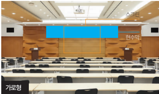
규 격 | 6.9(W) x 1(H) m 설치 위치 | 스크린 뒤 설치 방법 | 바텐 위자석 또는 케이블타이 고정 현수막 가공 | 현수막 하단 미싱
