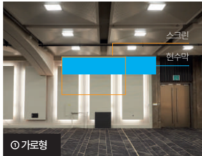
① 가로형 규 격 | 5(W) x 1(H) m 설치 위치 | 스크린 뒤 설치 방법 | 바텐 위 자석 또는 케이블타이 고정 현수막 가공 | 현수막 하단 봉미싱
